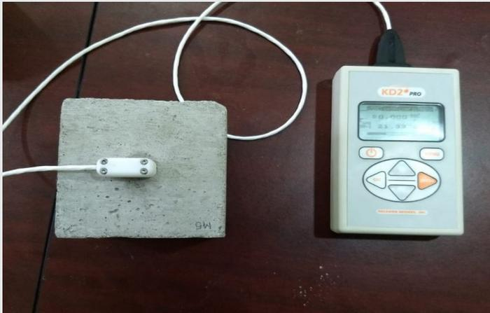
Figura 2. Instrumento Kd2 Pro realizando el análisis en el módulo M5.
